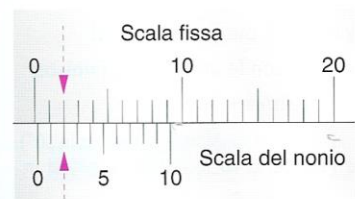
L'allineamento del trattino 2 indica una misura di 0,2 mm
